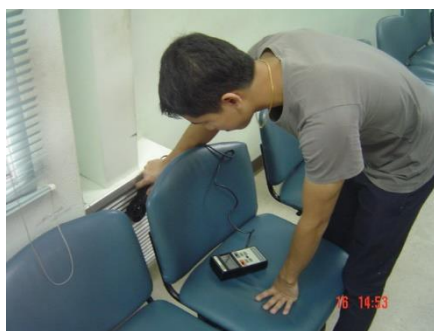
รูปแสดง การวัดความเร็วลมโดยใช้ Rotary Vane Anemometer
