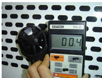
รูปแสดง การวัดความเร็วลมโดยใช้ Rotary Vane Anemometer
