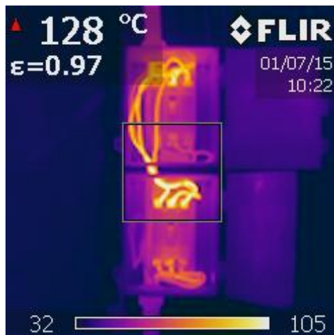
รูปที่แสดงการใช้กล้องถ่ายภาพความร้อนตรวจสอบจุดร้อนของเซอร์กิตเบรกเกอร์
